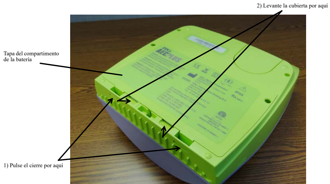
Figura 7: Retirada de la tapa del compartimento de la batería
